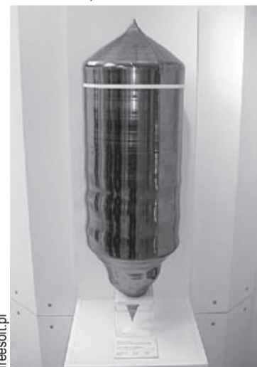
Monokryształ krzemu uzyskany „metodą Czochrańskiego”
